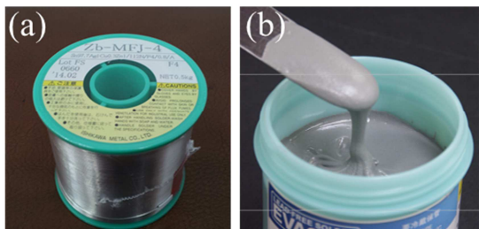
1mass% までの低 Ag 化を達成した鉛フリーはんだ (a) やに入りはんだ (b) ソルダペースト
